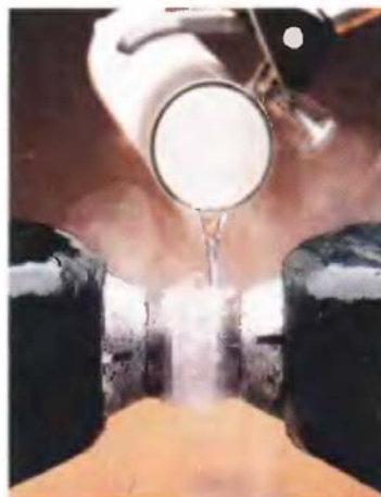
Paramagnetismo del oxígeno El oxígeno líquido es atraído por el campo magnético de un imán.
