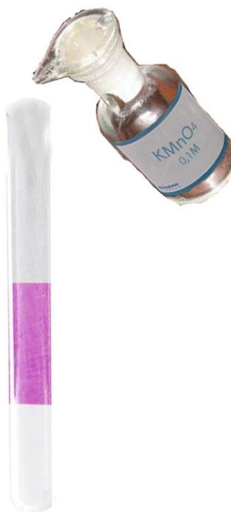
2. Se agrega 1mL de solución  $\text{KMnO}_4$  0.1M, se agita y se ve un precipitado marrón ( $\text{MnO}_2$ )
