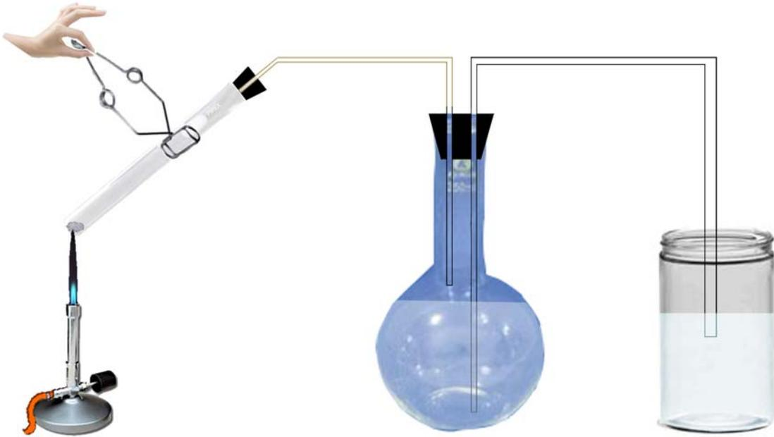
6. Al final de la reacción se mide la temperatura en el balón y también se mide el volumen de agua desplazado, echando el agua en una probeta graduada.
