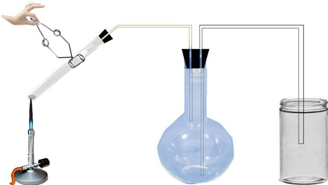
5. Luego de la reacción se obtiene Oxígeno que al pasar por el balón, desplaza al agua y esta se deposita en el frasco.
