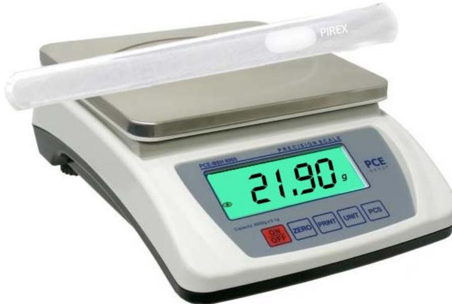
2. Se agrega una mezcla de  $MnO_2$  y  $KClO_3$  entre 0,8 a 1g (en este caso usaremos 1g) al tubo de ensayo e inmediatamente se vuelve a pesar para estar seguro de usar 1g.
