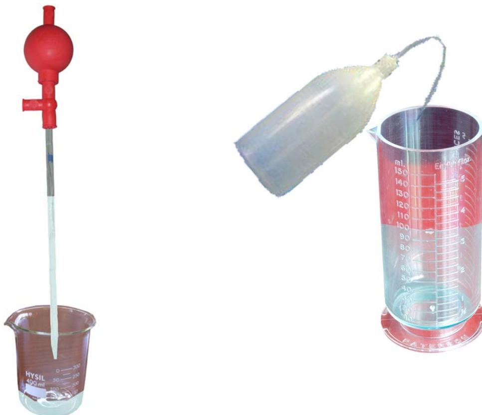
9. Con la pipeta se vierte el  $\text{H}_2\text{C}_2\text{O}_4$  al matraz erlenmeyer. Luego con la pipeta enjuagada se extrae 2 mL de solución  $\text{H}_2\text{SO}_4$  (1:1) de un vaso con  $\text{H}_2\text{SO}_4$  y se vierte en el matraz con la solución de  $\text{H}_2\text{C}_2\text{O}_4$  e inmediatamente se echan los 100 mL de agua de la probeta.
