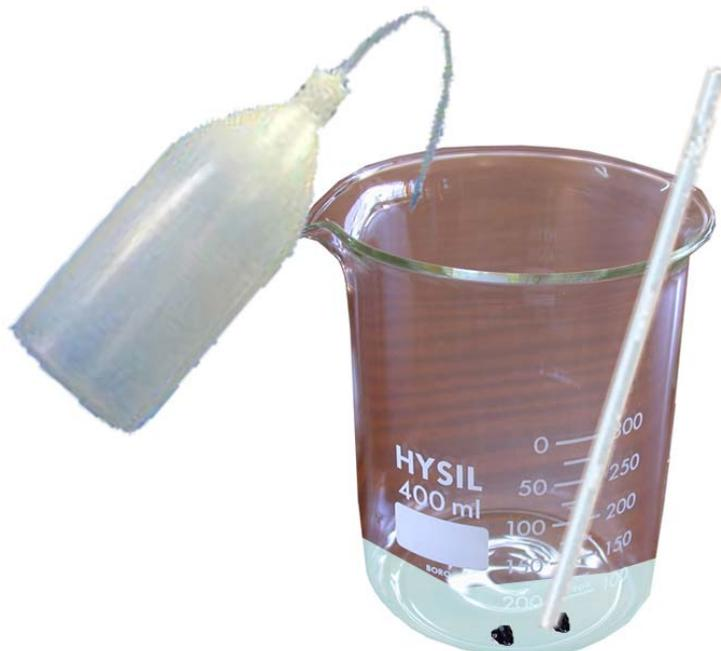
4. Usando el embudo de vidrio se trasvasa la solución a una fiola de 250 mL. Se lava el vaso procurando que no se pierda nada de sal, para así poderlo usar en el siguiente experimento.
