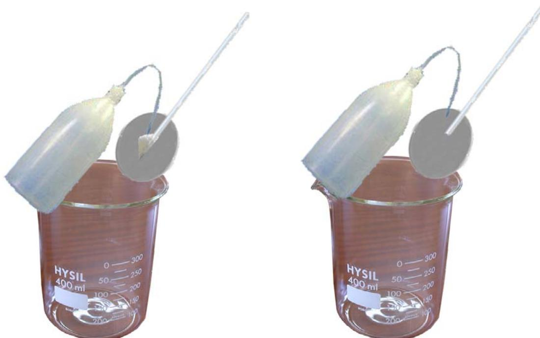
3. Se agrega 100 mL de agua destilada y con la bagueta se disuelven todos los cristales.
