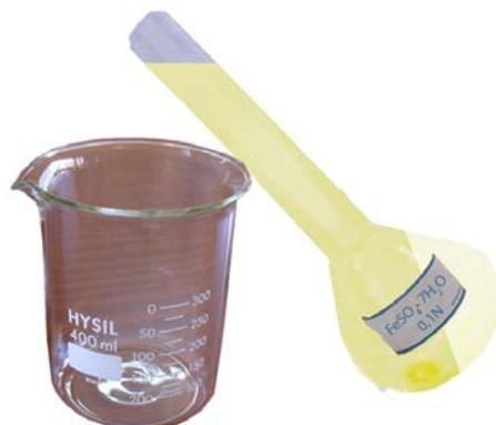
3. Se mide con una pipeta 20 mL de dicha solución contenida en el vaso. Se echa 100 mL de agua destilada a la probeta
