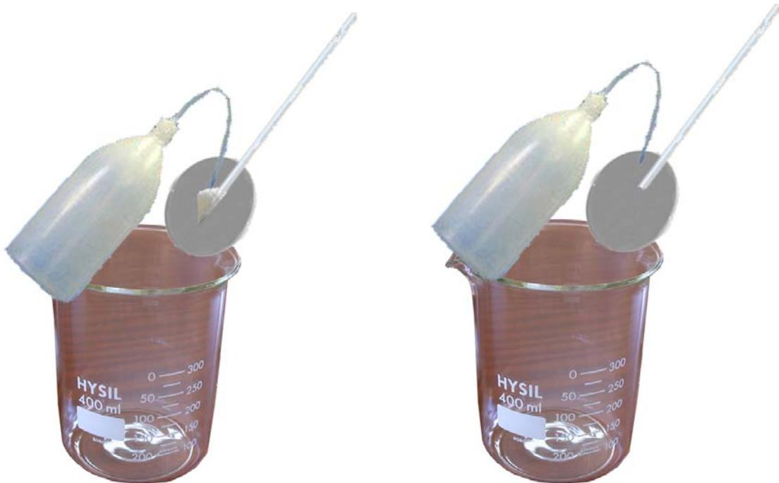
3. Se agrega 100 mL de agua destilada y con la bagueta se disuelven todos los cristales.
