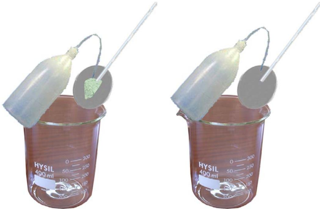
3. Se agrega 100 mL de agua destilada y con la bagueta se disuelven todos los cristales.
