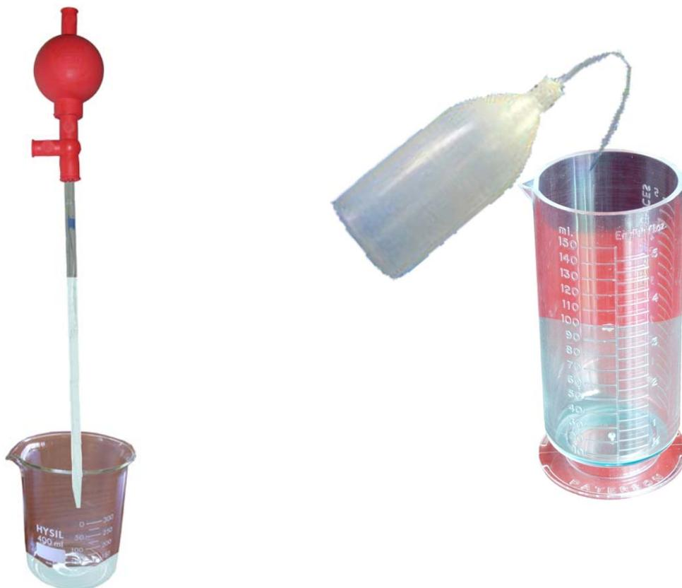
4. Con la pipeta se vierte el  $\text{H}_2\text{C}_2\text{O}_4$  al matraz erlenmeyer. Luego con la pipeta enjuagada se extrae 2 mL de solución  $\text{H}_2\text{SO}_4$  (1:1) de un vaso con  $\text{H}_2\text{SO}_4$  y se vierte en el matraz con la solución de  $\text{H}_2\text{C}_2\text{O}_4$  e inmediatamente se echan los 100 mL de agua de la probeta.
