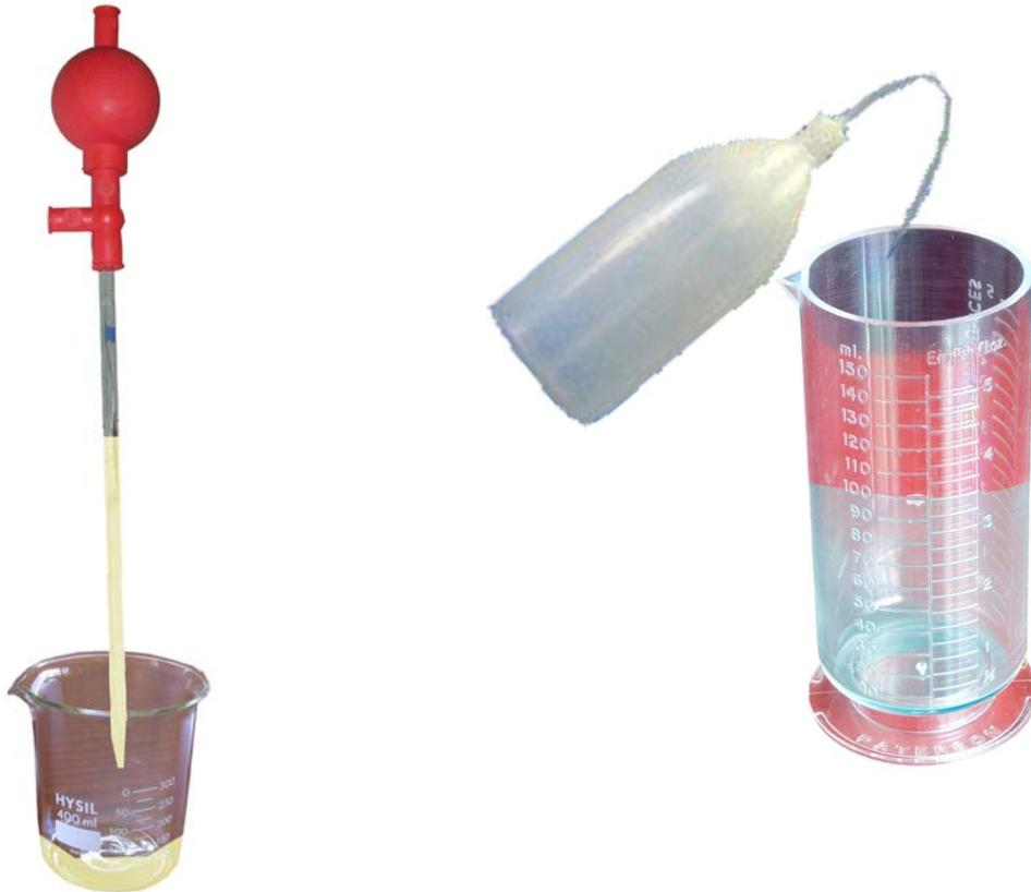
4. Con la pipeta se vierte el  $\text{FeSO}_4$  al matraz erlenmeyer. Luego con la pipeta enjuagada se extrae 3 mL de solución  $\text{H}_2\text{SO}_4$  (1:1) de un vaso con  $\text{H}_2\text{SO}_4$  y se vierte en el matraz con la solución de  $\text{FeSO}_4$  e inmediatamente se echan los 100 mL de agua de la probeta.
