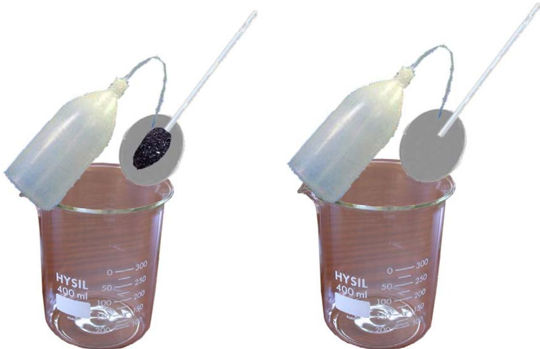
3. Se agrega 100 mL de agua destilada y con la bagueta se disuelve toda la sal.
