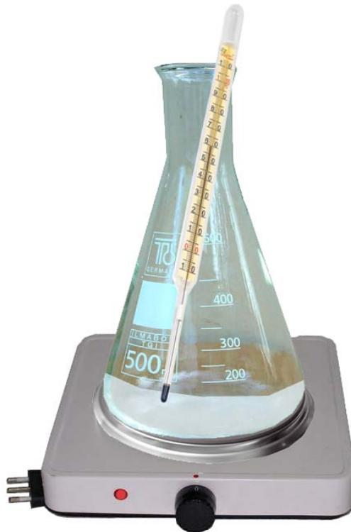
6. Se coloca el matraz sobre un fondo blanco, debajo de la bureta y se procede a titular en caliente, agregándole solución de  $\text{KMnO}_4$  y agitando continuamente.
