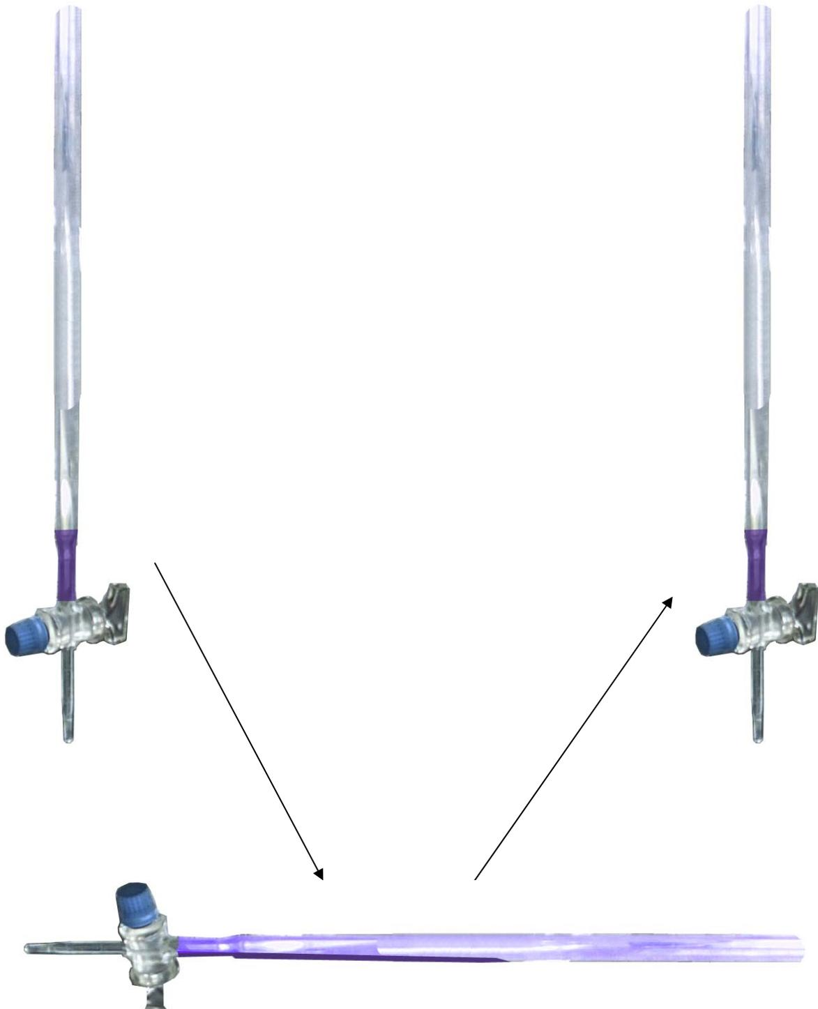
2. Se fija la bureta en un soporte universal con una pinza y empleando un embudo se vierte la solución de Permanganato de Potasio por encima de la marca del 0, luego se abre la llave de la bureta para llenar el tubo terminal y evitar que se llene de burbujas de aire, dejándose en el nivel de 0.
