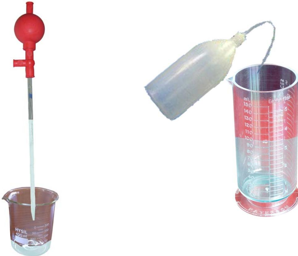
5. Con la pipeta se vierte el  $\text{Na}_2\text{C}_2\text{O}_4$  al matraz erlenmeyer. Luego con la pipeta enjuagada se extrae 5 mL de solución  $\text{H}_2\text{SO}_4$  (1:1) de un vaso con  $\text{H}_2\text{SO}_4$  y se vierte en el matraz con la solución de  $\text{Na}_2\text{C}_2\text{O}_4$  e inmediatamente se echan los 100 mL de agua de la probeta.
