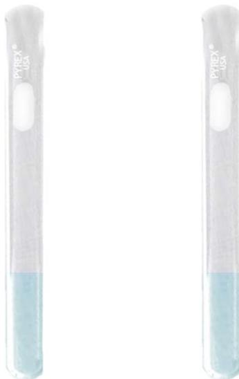
3. Al primer tubo con 5mL de HCl se le añade una gota de Anaranjado de Metilo y al otro tubo se le añade una gota de Naranja IV.
