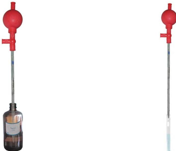
2. A partir del tubo N° 1, mediante diluciones sucesivas se preparan soluciones de HCl de  $1 \times 10^{-2}M$ ,  $1 \times 10^{-3}M$  y  $1 \times 10^{-4}M$ . Para lo cual en otro tubo el que le designaremos N° 2 se añade 1 mL de HCl y para obtener la concentración  $1 \times 10^{-2}M$ , deberemos de añadirle 9 mL de agua.
