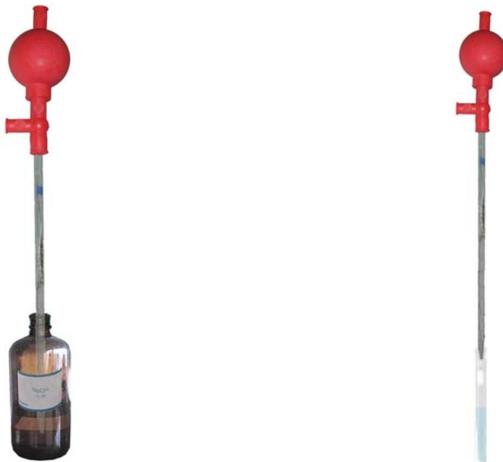
2. A partir del tubo N° 1, mediante diluciones sucesivas se preparan soluciones de NaOH de  $1 \times 10^{-2}\text{M}$ ,  $1 \times 10^{-3}\text{M}$  y  $1 \times 10^{-4}\text{M}$ . Para lo cual en otro tubo el que le designaremos N° 2 se añade 1 mL de NaOH y para obtener la concentración  $1 \times 10^{-2}\text{M}$ , deberemos de añadirle 9 mL de agua.
