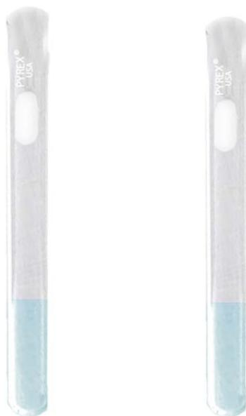
3. Al primer tubo con 5mL de NaOH se le añade una gota de Alizarina y al otro tubo se le añade una gota de Índigo Carmín.
