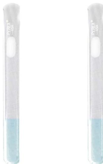
3. Al primer tubo con 5mL de  $\text{NH}_4\text{OH}$  se le añade una gota de Alizarina y al otro tubo se le añade una gota de Índigo Carmín.
